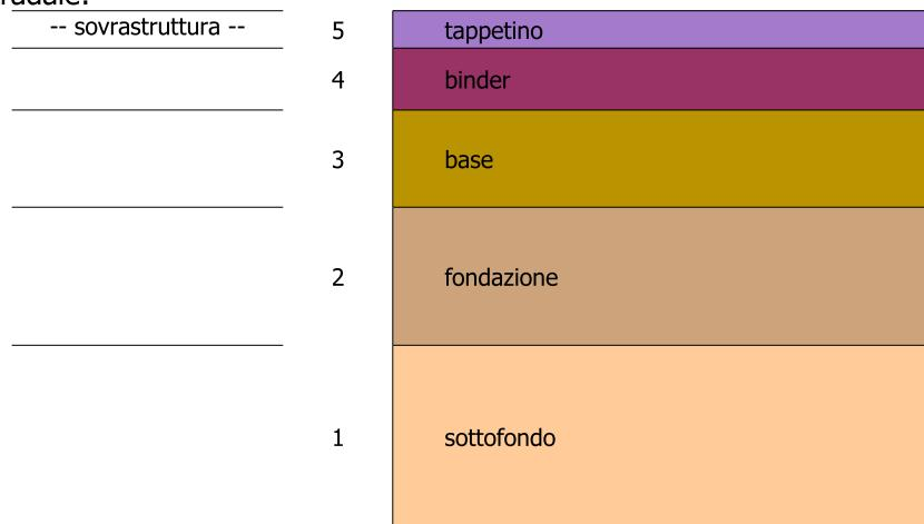
• sottofondo (terreno naturale in situ o ultimo strato del rilevato);
