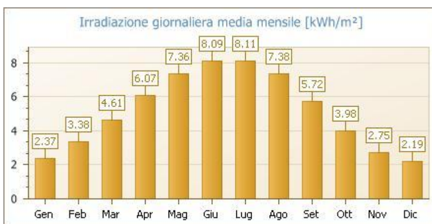
Fig. 1: Irradiazione giornaliera media mensile sul piano orizzontale [kWh/m 2 ]- Fonte dati: UNI 10349 - Località di riferimento: AGRIGENTO (AG)/PALERMO (PA)
